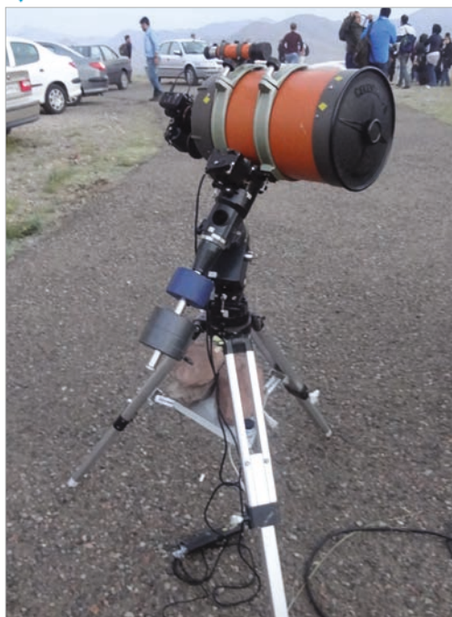
5. L'association C8-Alpha 7s, sur monture Vixen GP, ou les outils d'un sauvetage photographique.
